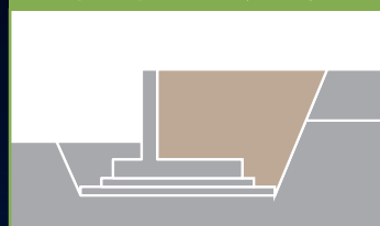
擁壁等埋戻し裏込材
